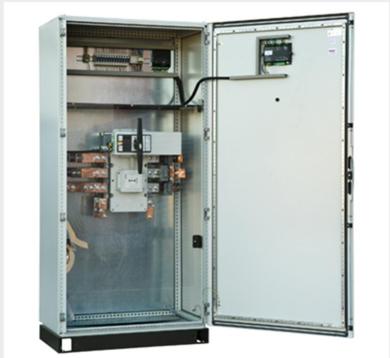
Пульт оснащен электронным блоком, обнаруживающим отказ питания от электросети, и двумя контакторами с механической и электрической фиксацией или с моторизованным приводом, которые управляются указанным блоком и осуществляют переключение питания нагрузки между УСТАНОВКОЙ и ЭЛЕКТРОСЕТЬЮ
